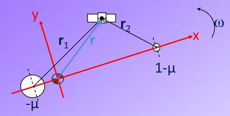
$$\ddot{\vec{r}} + \vec{\omega} \times \left(\vec{\omega} \times \vec{r}\right) + 2\vec{\omega} \times \dot{\vec{r}} = -\frac{(1-\mu)}{r^3}\vec{r_1} - \frac{\mu}{r^3}\vec{r_2}$$
