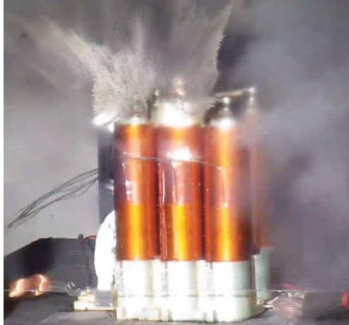
Batt. Module explosion
